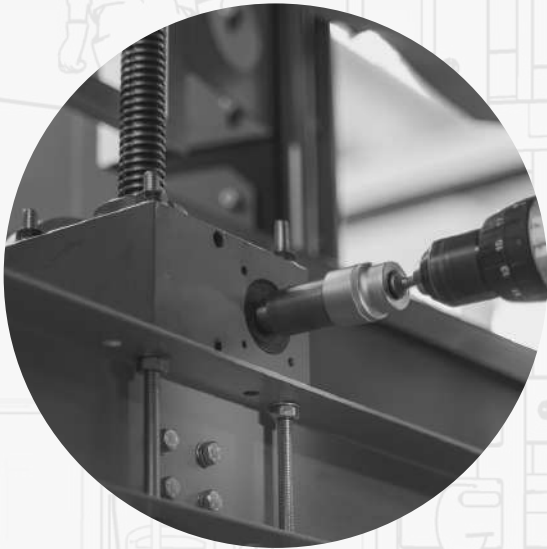
Regolazione altezza di sbarco con avvitatore elettrico Landing height adjustment with an electric screwdriver
