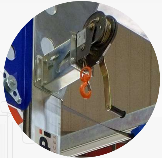
Argano manuale per sollevamento attrezzature in quota Manual winch for lifting equipment to height
