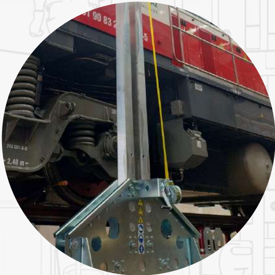
Regolazione altezza di sbarco con argano manuale Landing height adjustment with manual winch
